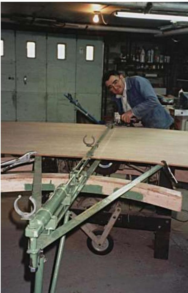
Machine construite pour découper le contre-plaqué extérieur suivant le diamètre de l'abri (ø 5 mètres).
