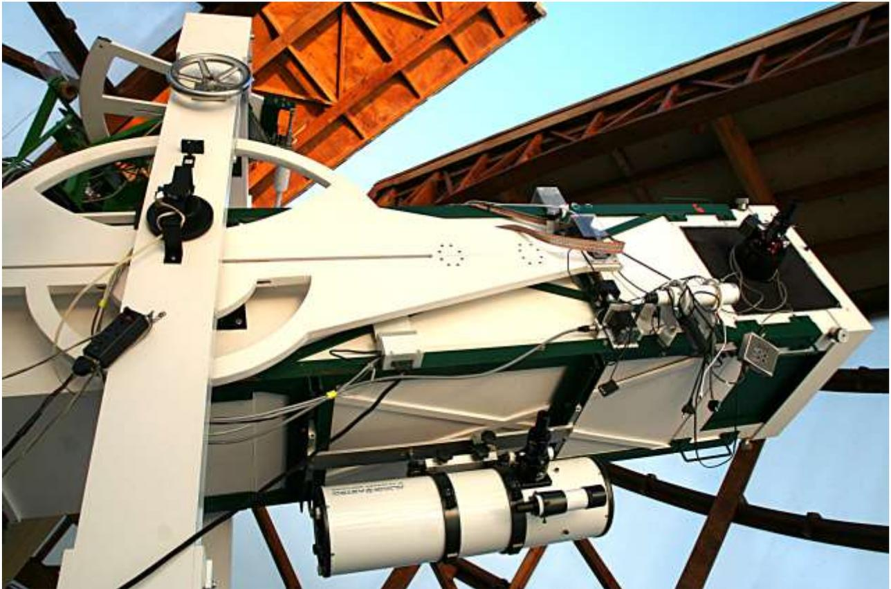
L'instrument complet, équipé de son télescope guide de  $\varnothing$  200mm.
