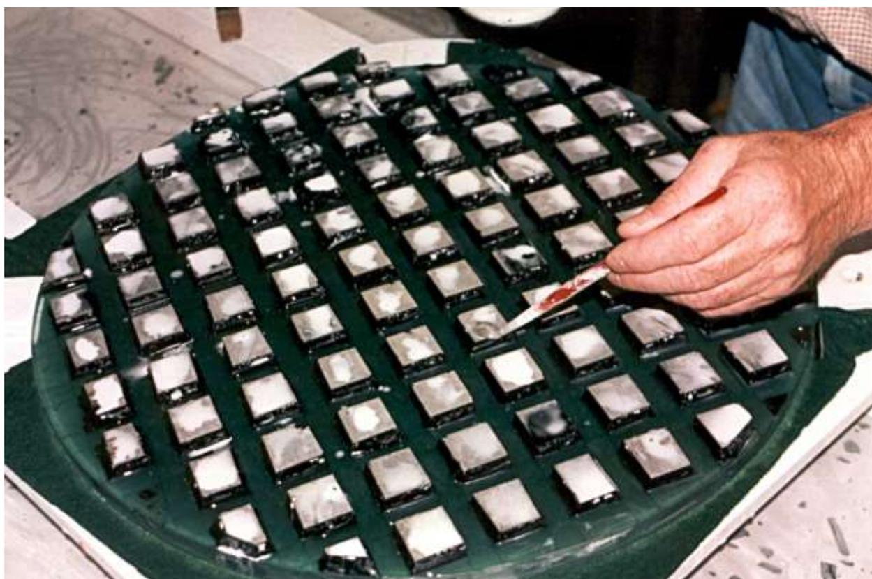
Les carrés de poix sont recouverts d'oxyde de zirconium.
