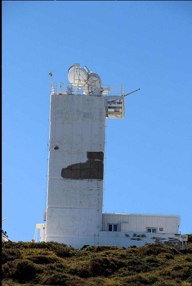
**Le télescope solaire suédois (STT)**: sidérostât muni d'un miroir de 1 mètre. Images très détaillées de la surface du soleil: des granules de 70 km sont détectées. Il est à ce jour le meilleur télescope solaire du monde. Ce télescope étudie les champs magnétiques, le mystère des taches solaires ainsi que la dynamique de la couche supérieure de l'atmosphère solaire...
