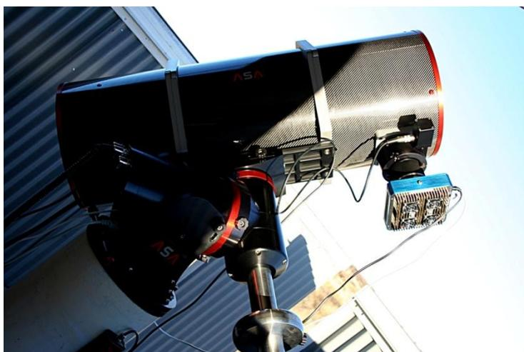
Le télescope ASA de  $\varnothing$  300 mm.
