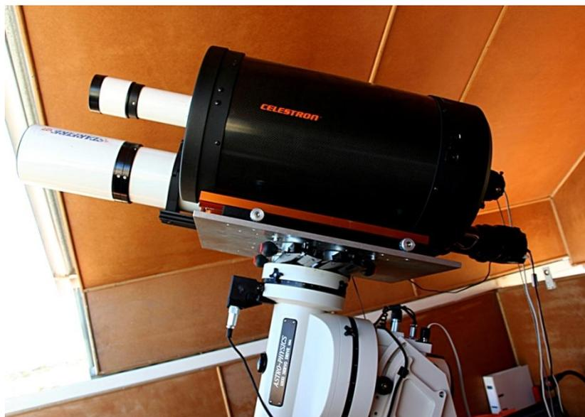
Le télescope C 11 et la lunette de  $\varnothing$  108 mm.
